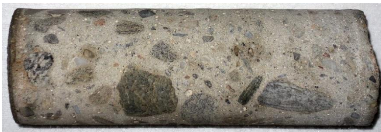
Obr. 10 Odebraný jádrový vývrt V2 (X 204)
