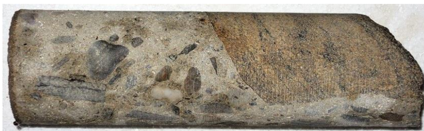
Obr. 12 Odebraný jádrový vývrt V4 (X 206)
