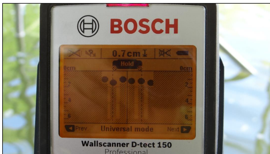
Obr. 19 Elektromagnetický indikátor betonářské výztuže
