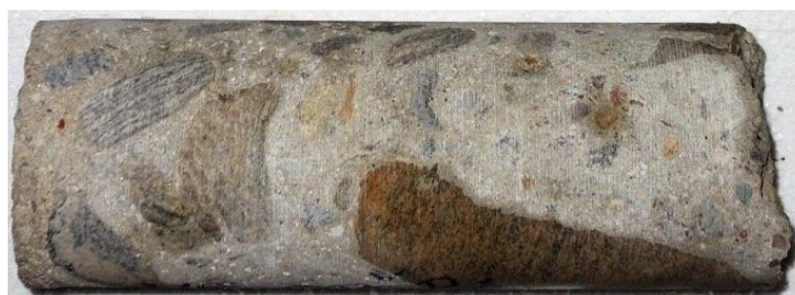
Obr. 13 Odebraný jádrový vývrt V5 (X 207)
