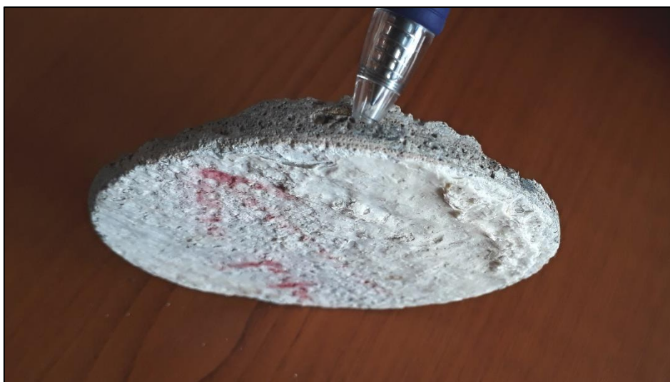
Obr. 39 Mocnost výluhů na povrchu betonu (detail na povrchovou vrstvu jádrového vývrtu V7 odebraného z konstrukce)
