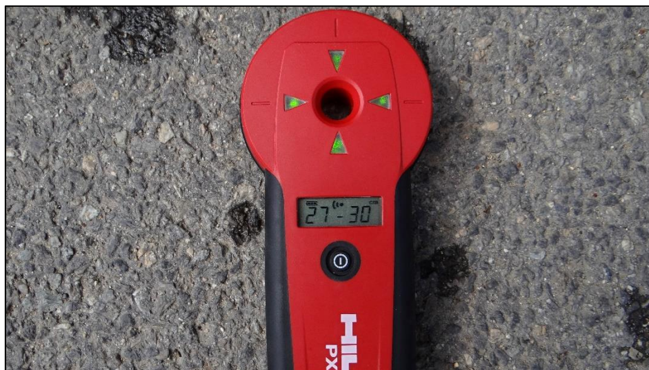
Obr. 33 Hilti PX 10R (přijímač) umístěný na povrchu vozovky nad vysílačem. Na displeji je uvedena hodnota celkové změřená tloušťky mostovky
