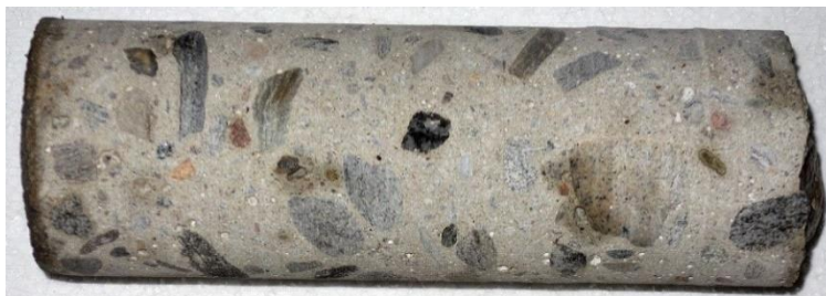
Obr. 9 Odebraný jádrový vývrt V1 (X 203)
