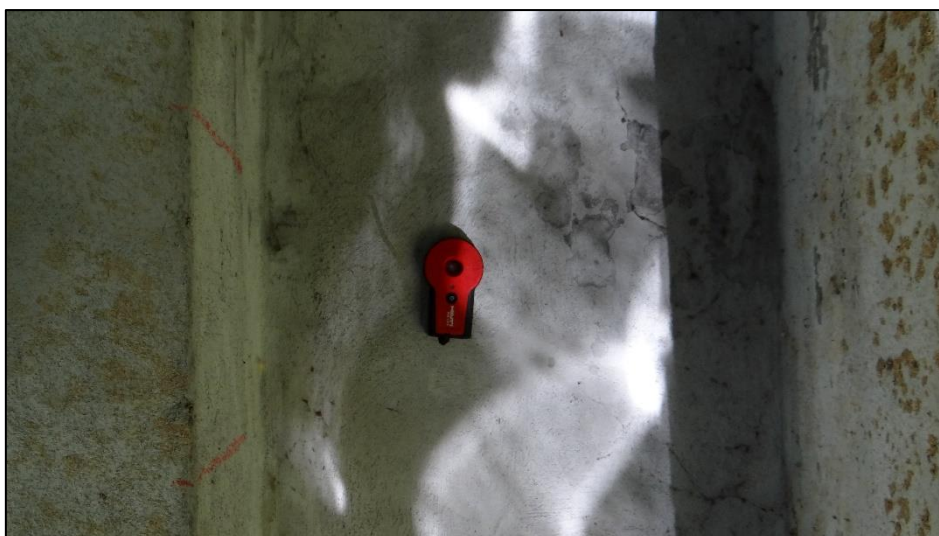
Obr. 32 Hilti PX 10T (vysílač) umístěný na spodním líci desky
