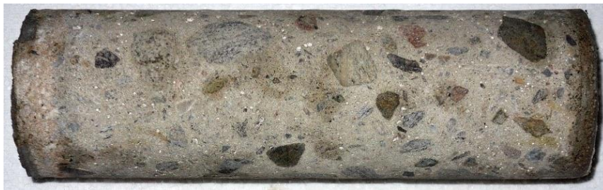
Obr. 14 Odebraný jádrový vývrt V6 (X 208)
