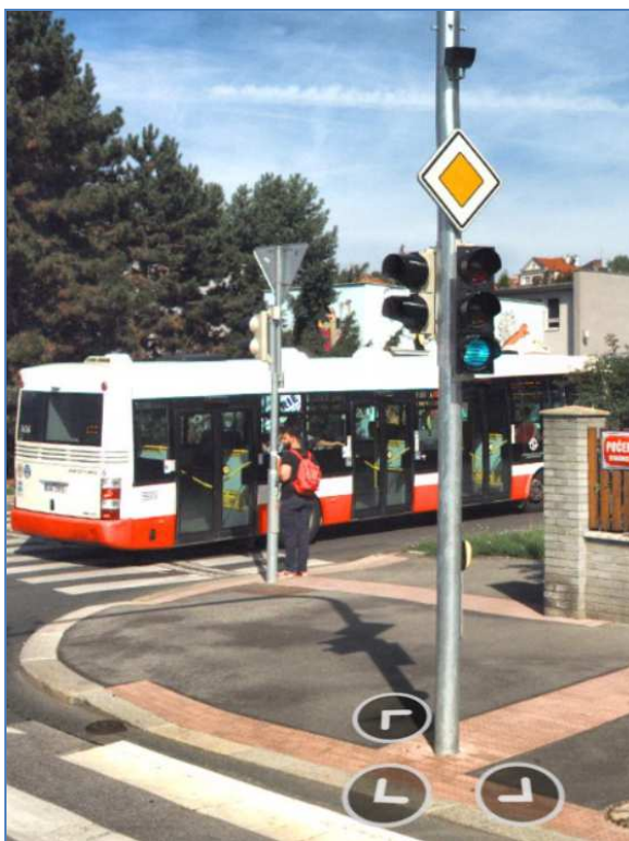
Obrázek 2: Příklad osazení informativních výzvodých návěstidel na stožáru SSZ.
